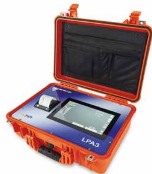
Il contatore di particelle LPA3, vero e proprio laboratorio portatile.
